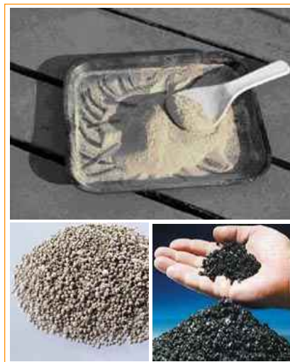
Figura 1. Comparación entre a) cenizas livianas y b) escoria de caldera o cenizas pesadas.
