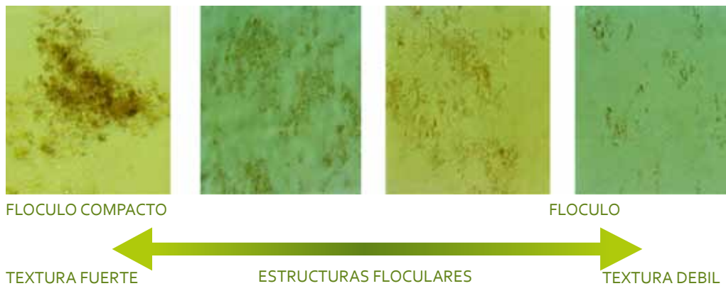
Figura 10. Estructura del flóculo. Fotografía: Grupo de Química y Microbiología del Agua. Instituto Universitario de Ingeniería del Agua y Medio Ambiente (IIAMA).
