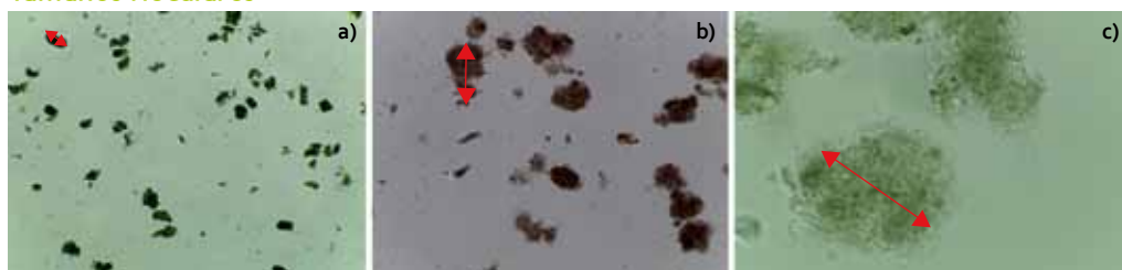
Figura 9. Tamaño del flóculo: a) <150 micras; b) 150-500 micras; c) > 500 micras. Fotografías: Grupo Ingeniería y Biotecnología Ambiental GIBA.
