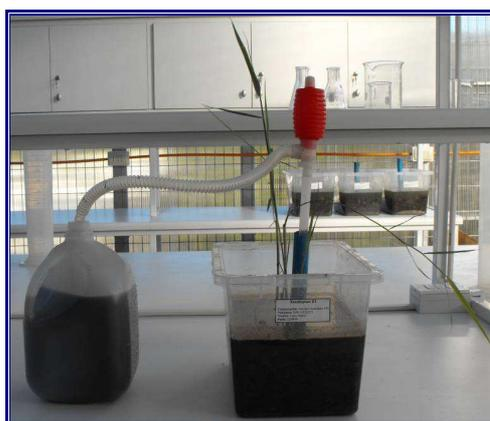
**Figura 4.** Vaciado de los mesocosmos mediante un sifón
