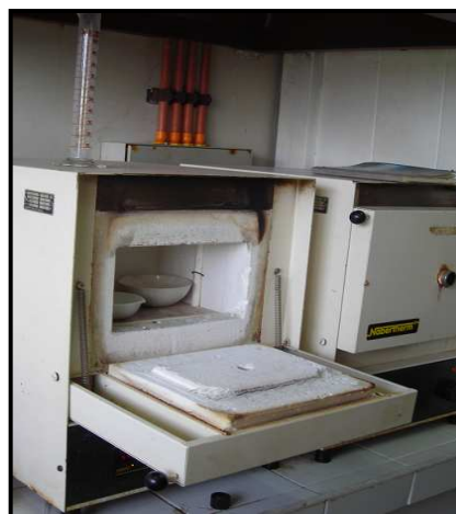
Figura 3. a) Proceso de secado a 105^\circ\text{C} (ST y SST); y b) proceso de calcinación a 545^\circ\text{C} (SV y SSV).
