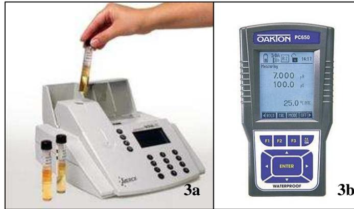
**Figura 3 a.** Espectrofotómetro para kits Spectroquant NOVA-60; **3 b** equipo multiparámetro OAKTON PC650.
