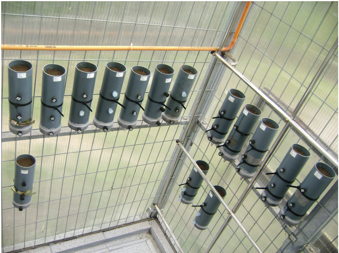
Figura 6. Montaje de las columnas de suelo (sistema alimentado con purín crudo y efluente tratado con 700 kg N/ha/año) en el laboratorio piloto del Grupo de Ingeniería y Biotecnología Ambiental del Centro EULA.
