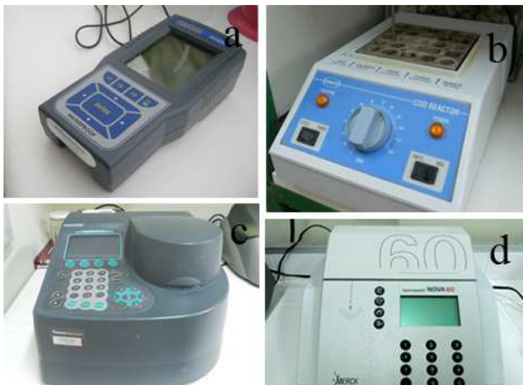
Figura 5. Equipos utilizados para la medición de parámetros físico-químicos del purín de cerdo y lixiviados de las columnas de suelo. a) Equipo multiparamétrico; b) Digestor para DQO_T ; c) Espectrofotómetro; d) Equipo Fotométrico NOVA-60.
