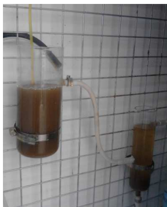
Figura 4. Reactor de lodos activados.
