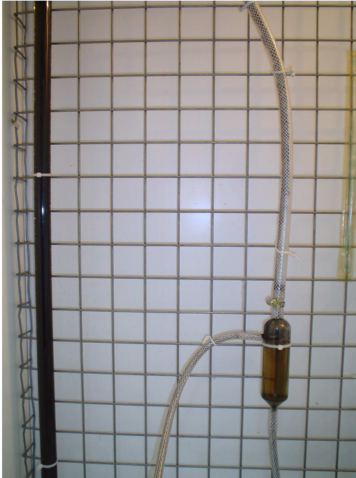
Figura 9.3 Principal sistema del reactor, se aprecia el lodo a lo largo del tubo (fluidizado), junto con el recipiente de recirculación.
