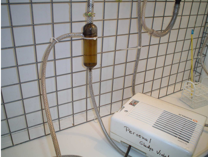
Figura 9.4 En esta fotografía se aprecia el sistema de calefacción de la cámara, mantenida en 37°C
