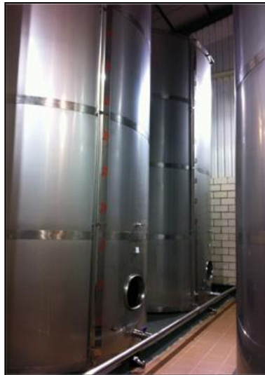
Figura 17.- Estanques de sangrado para almacenamiento de aceite, previo a la comercialización y posterior a la separación líquido-líquido (Pieralisi).
