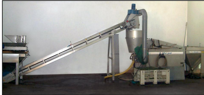
Figura 11.- Control de peso en la línea continua de ingreso de olivas, posterior al lavado y previo a la preparación de la pasta.
