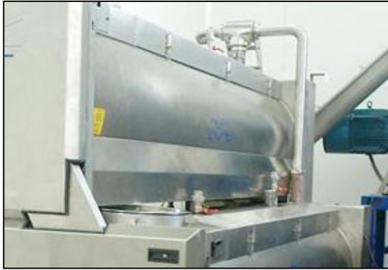
Figura 15.- Decanter Horizontal para separación sólido-líquido previo a la separación líquido-líquido y posterior al termo batido (Pieralisi).
