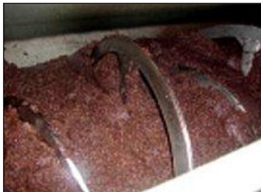
Figura 13.- Batido de olivas en termobatidor luego del proceso de molienda y previo a la etapa de separación sólido-líquido.
