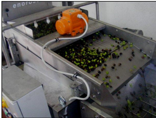
Figura N°10.- Zona de lavado de las olivas, posterior a la recepción y previo a la etapa de molienda (Pieralisi).
