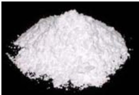
**Figura 21.** Muestra de polvos finos provenientes de PPT del horno de cal
