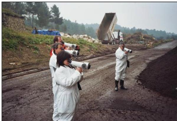
**Figura 9.** Determinación del umbral de detección mediante olfatometría de campo
