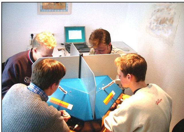
**Figura 8.** Determinación del umbral de detección mediante olfatometría dinámica
