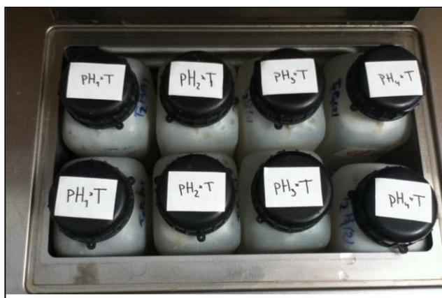
**Figura 14.** Reactores batch con control de temperatura y pH
