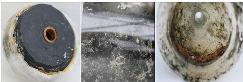
**Figura 18.** Precipitación de sulfato en el reactor UASB
