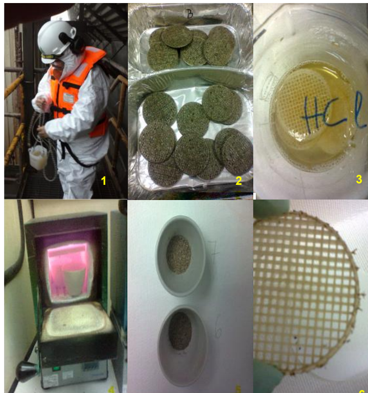
Figura 7: Donde; 1, Toma de muestras; 2, Carriers; 3, lavado; 4, mufla; 5, SSV; 6, Carrier limpio.
