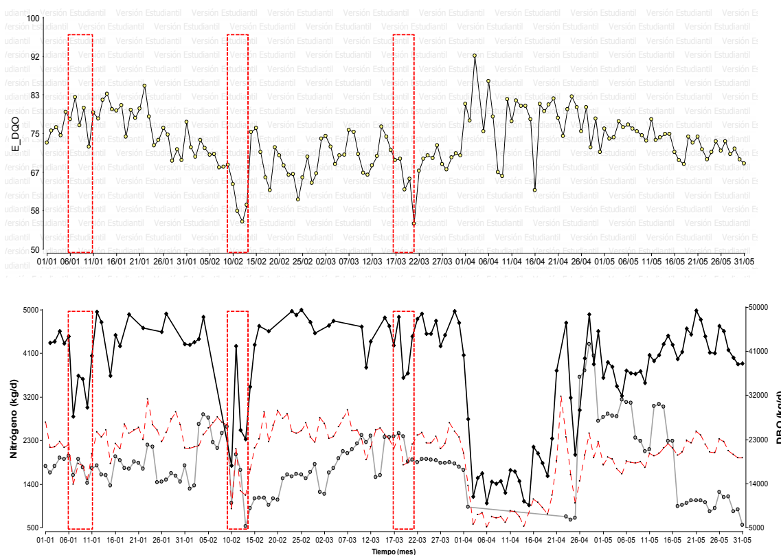
Figura 10 Relación entre DBO 5 :N y cómo influye en la de salida la apropiada dosificación de nitrógeno. Donde: Entrada DBO (◆); Salida DQO (●); N 2 disponible (●); N 2 teórico (---).
