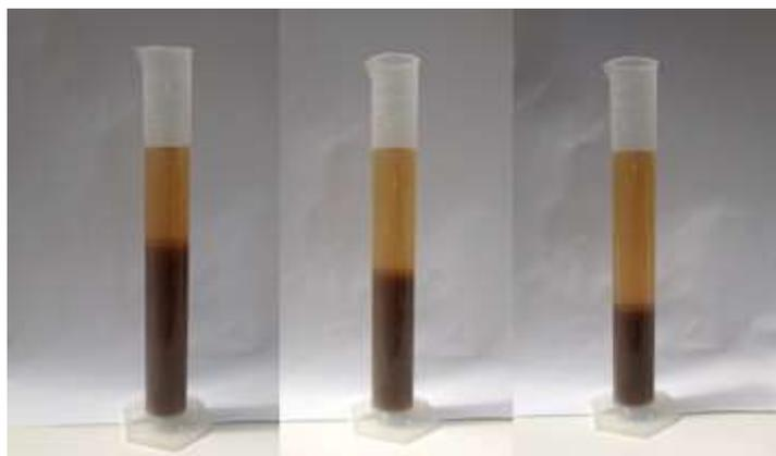
**Figura 5.** Determinación experimental del IVL.
