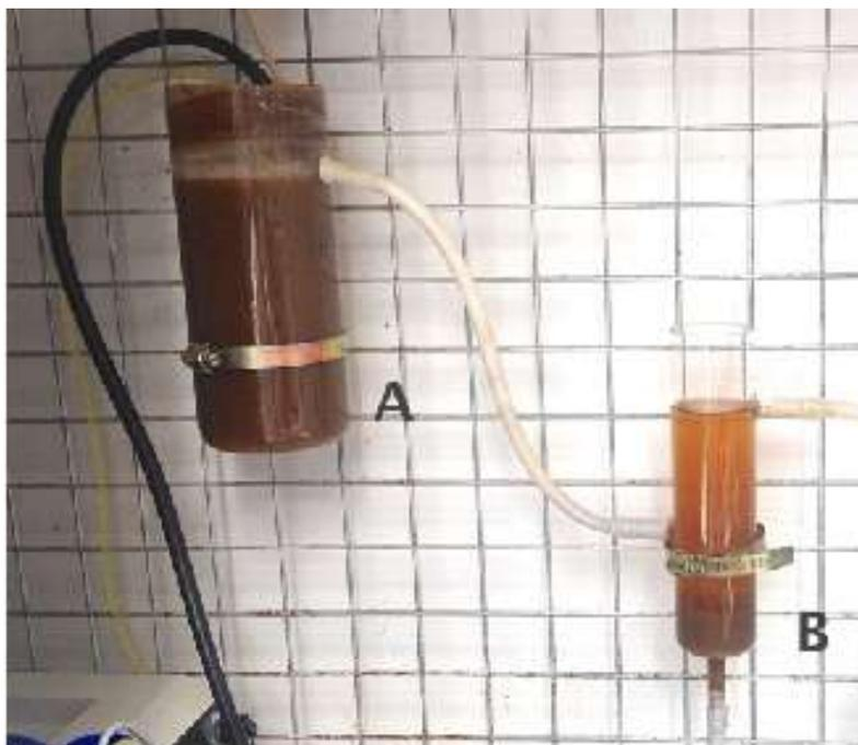
**Figura 4.** Reactor de lodos activados (A: Reactor; B: Sedimentador).
