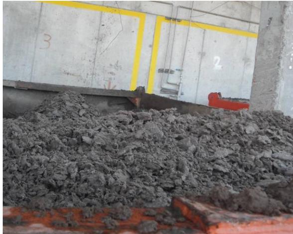
**Figura 7.** Mezcla de lodos de tratamiento de efluentes
