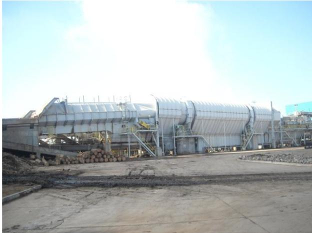
**Figura 3. Descortezador de madera**
