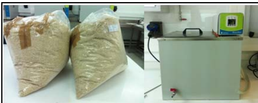
Figura 7. Pulpa de eucaliptus, Baño termostatzado utilizado en el blanqueo
