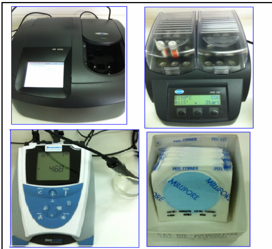
Figura 8. Equipamiento utilizado para medir los siguientes parámetros: a) DQO (espectrofotómetro de absorción molecular modelo DR 5000, HACH); b) DQO (termoreactor, modelo D98 200, HACH); c) pH (pHmetro, Thermo scientific modelo orion 2 star, sonda modelo 9157 BN, arquimed). Filtros membranas Wathman 0.45 \mu\text{m} .
