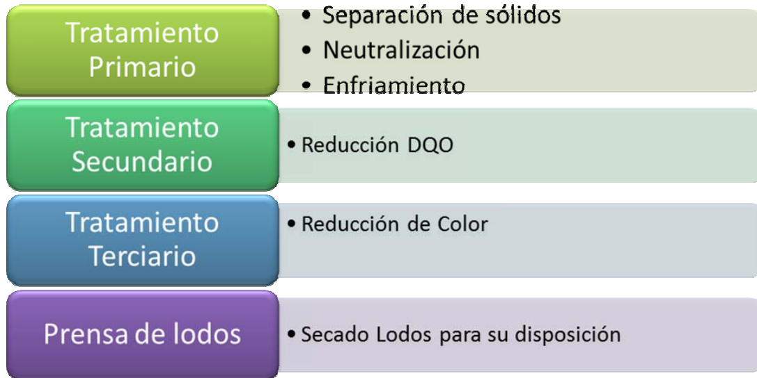
Figura 22 Planta de tratamiento de efluentes
