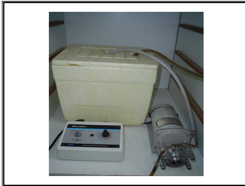
Figura 4: Sistema de bomba que controla el TRH de la laguna aireada, y sistema de mantenimiento de influente y recolección de efluente.
