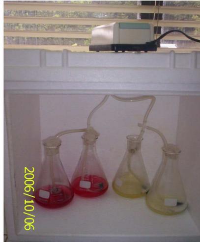
Figura 3. Sistema de incubación bacterial para enriquecer un cultivo de nitrificantes.
