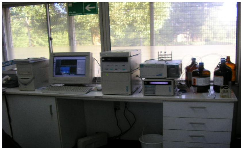
**Figura 10.** Cromatógrafo líquido de alta resolución (HPLC) utilizado para la determinación de la concentración de clorofenoles.
