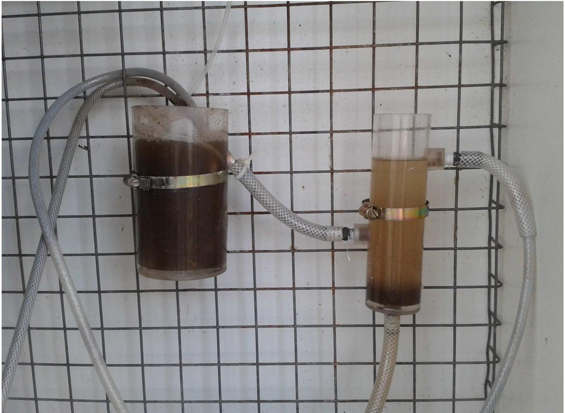
**Figura 2.** Sistema de lodos activados.
