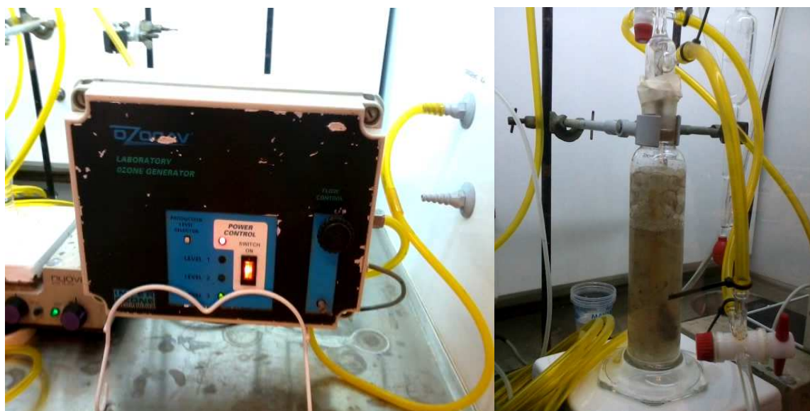
Figura 7. Sistema de ozonización, a) Ozonizador OZOCAY, b) Tubo lavador de gases Pyrex 250 mL.
