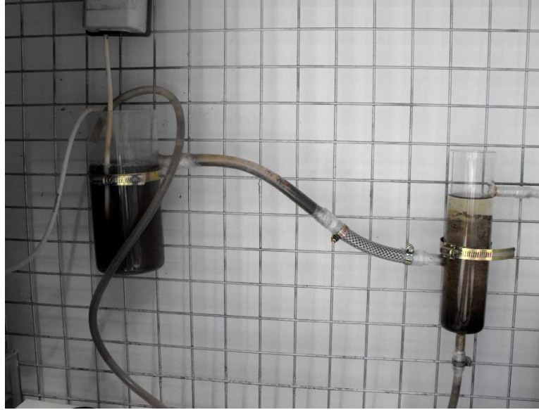
Figura 6. Sistema de tratamiento de lodos activados a escala laboratorio.
