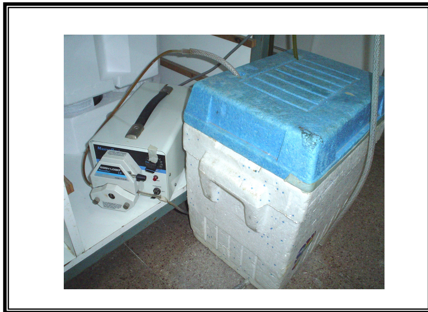
Figura 3. Bomba alimentadora del efluente en el sistema de laguna aireada.
