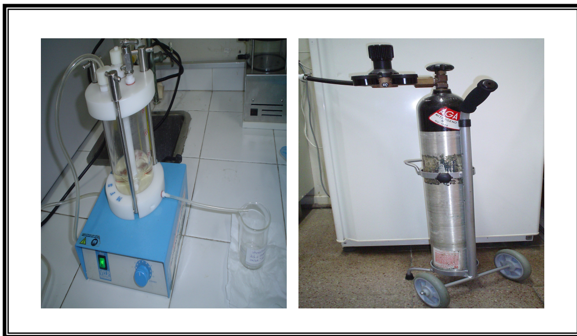
Figura 6. Sistema de ultrafiltración.
