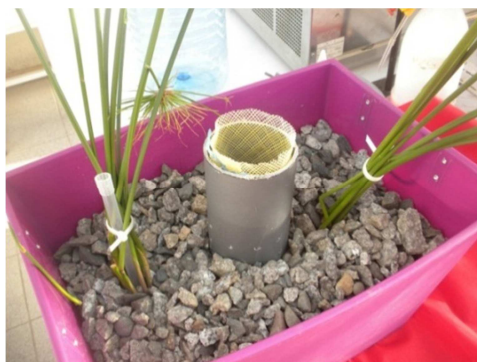
Figura 9. Tubo muestreador con cilindro de malla con material de soporte retenido.
