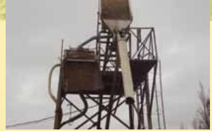
Sedimentador empleado en Tecnologías de Abatimiento Primario
