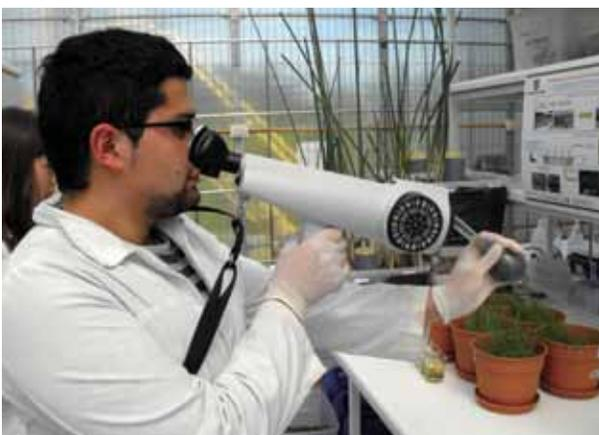
Figura 2. Determinación olfatométrica.
