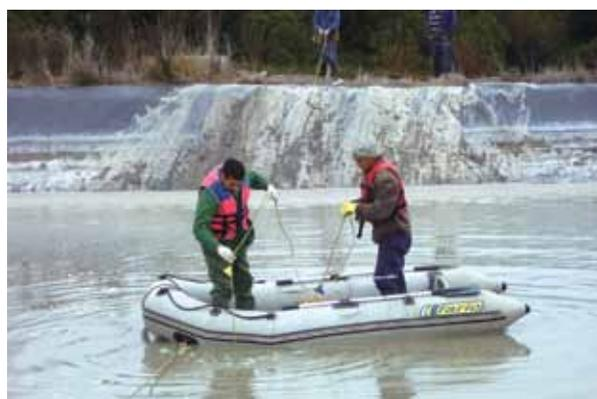
Figura 3. Muestreo de la laguna de almacenamiento y medición de altura de lodo.
