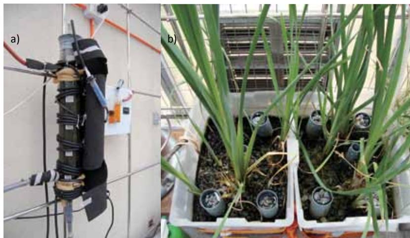
**Figura 2.** a) Reactor anaeróbico (UASB); b) Humedal artificial a escala de mesocosmos.
