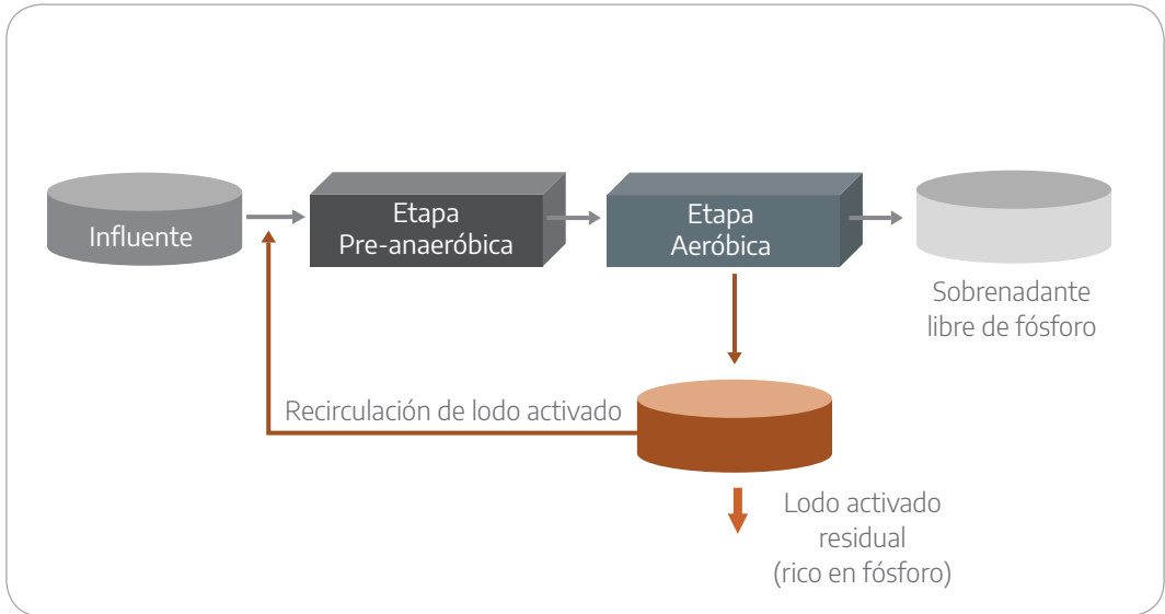
Figura 4. Configuración típica del proceso Phoredox, para la eliminación de P en la corriente principal.
